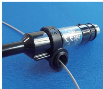
Guarde la sonda con la punta de la sonda hacia abajo. Esto ayudará a evitar que entren burbujas de aire en la periferia del transductor.
