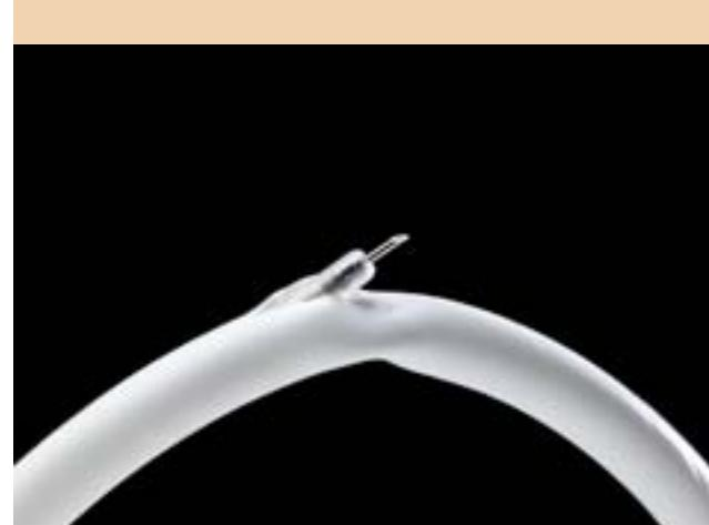
Obstrucción la boquilla de aire/agua, flujo deficiente de aire/agua.
