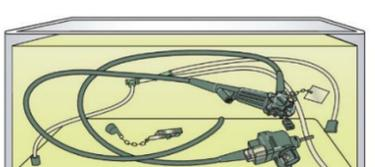
Mantenha todo o equipamento imerso em solução desinfetante de acordo com o tempo e a temperatura recomendados pelo fabricante do desinfetante. Use um temporizador para medir o tempo exato do contato.
