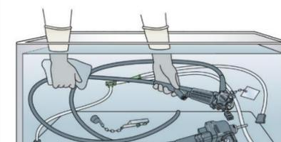
Desconecte a tampa dos canais e o tubo de injeção. Mergulhe o endoscópio e as peças separadas em água limpa. Enxágue bem todas as superfícies externas.
