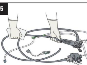
Desconecte todos os acessórios do endoscópio. Seque o endoscópio e os acessórios com um pano umedecido em álcool. Certifique-se de que o equipamento esteja completamente seco antes do armazenamento.
